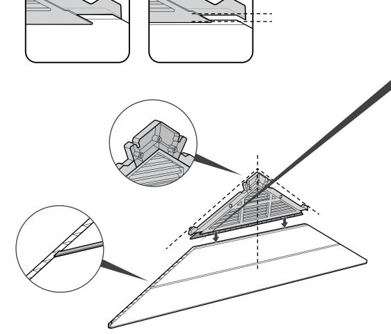
No pre-drilled holes | 미리 뚫어 놓은 구멍은 없으며 위치에 맞게 조립 후 나사로 결합시켜 주십시오
