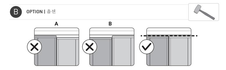
If you find that the shed is not level, use shims on either side of the shed or door | 설치장소 바닥 수평이 맞지 않아 문 높이가 맞지 않을 경우 별도의 쐐기를 사용하여 문 높이를 맞춰 주십시오
