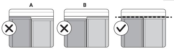
If you find that the shed is not level, use shims on either side of the shed or door | 설치장소 바닥 수평이 맞지 않아 문 높이가 맞지 않을 경우 별도의 쐐기를 사용하여 문 높이를 맞춰 주십시오.
